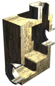
Desenho 3: Poço de visita com degrau (corte)
